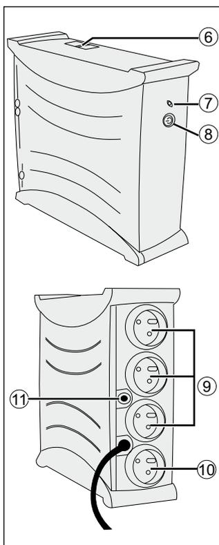
► **Nabíjanie batérie** : UPS nabíja svoju batériu hneď, ako je pripojené do elektrickej siete, bez ohľadu na stav tlačidla ⑧. Pri prvom použití je batéria schopná samostatného fungovania až po nabití počas 8 hodín. Na zachovanie čo najlepšej prevádzky sa odporúča nechať UPS neustále zapojené do elektrickej siete.
