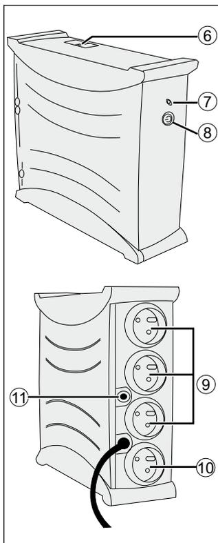
▶ **Az akkumulátor töltése:** Az UPS készülék a hálózati áramba való bekötést követően azonnal, bármilyen kezelőgombállásnál tölti az akkumulátort, (8). Az első használatbavételkor az akkumulátor csupán 8 óra feltöltési idő elteltével működik teljes teljesítménnyel. Az akkumulátor teljes teljesítményének fenntartásához ajánlatos az UPS készüléket állandóan a hálózati áramra csatlakoztatni.
