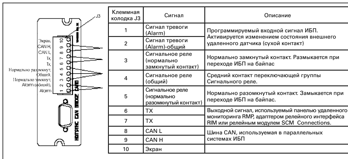
Рис. 40. Передняя панель адаптера «Hot Sync CAN Bridge»
