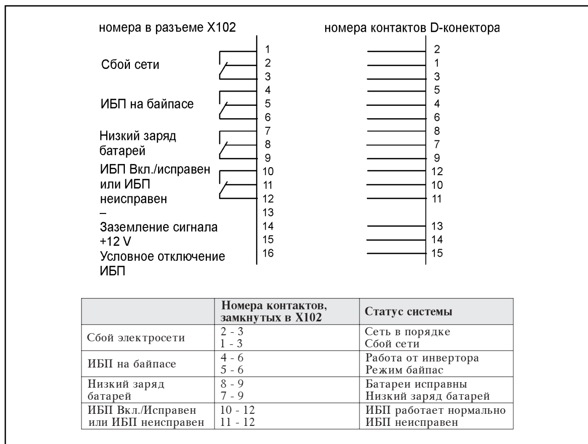
Рисунок 26. Релейный интерфейс ИБП (X102).
