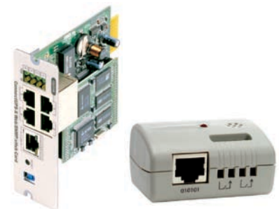
Адаптер Web/SNMP с датчиком параметров окружающей среды.
