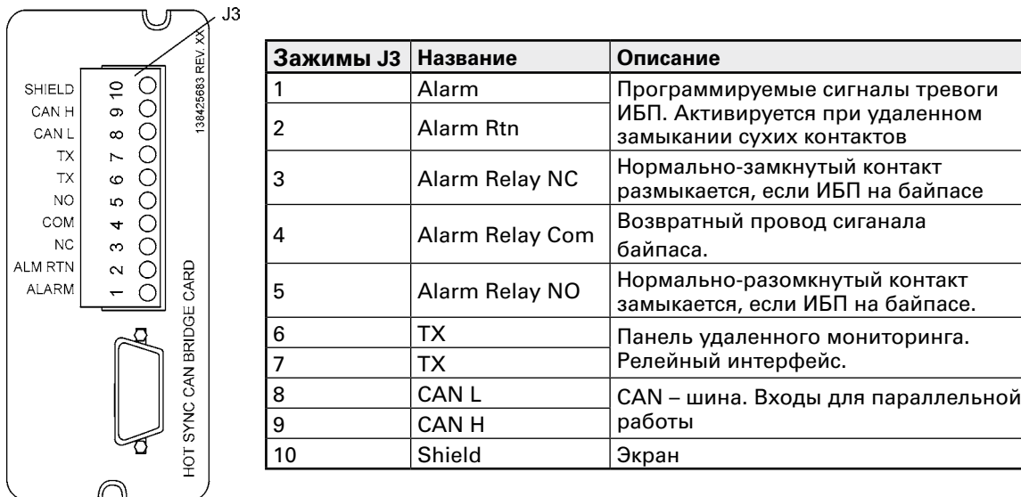
Рисунок 44. Плата XSlot Hot Sync и контактный интерфейс
