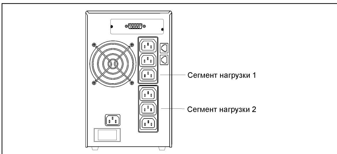
Рисунок 10. Сегменты нагрузки на ИБП 1000 ВА и 1500 ВА
