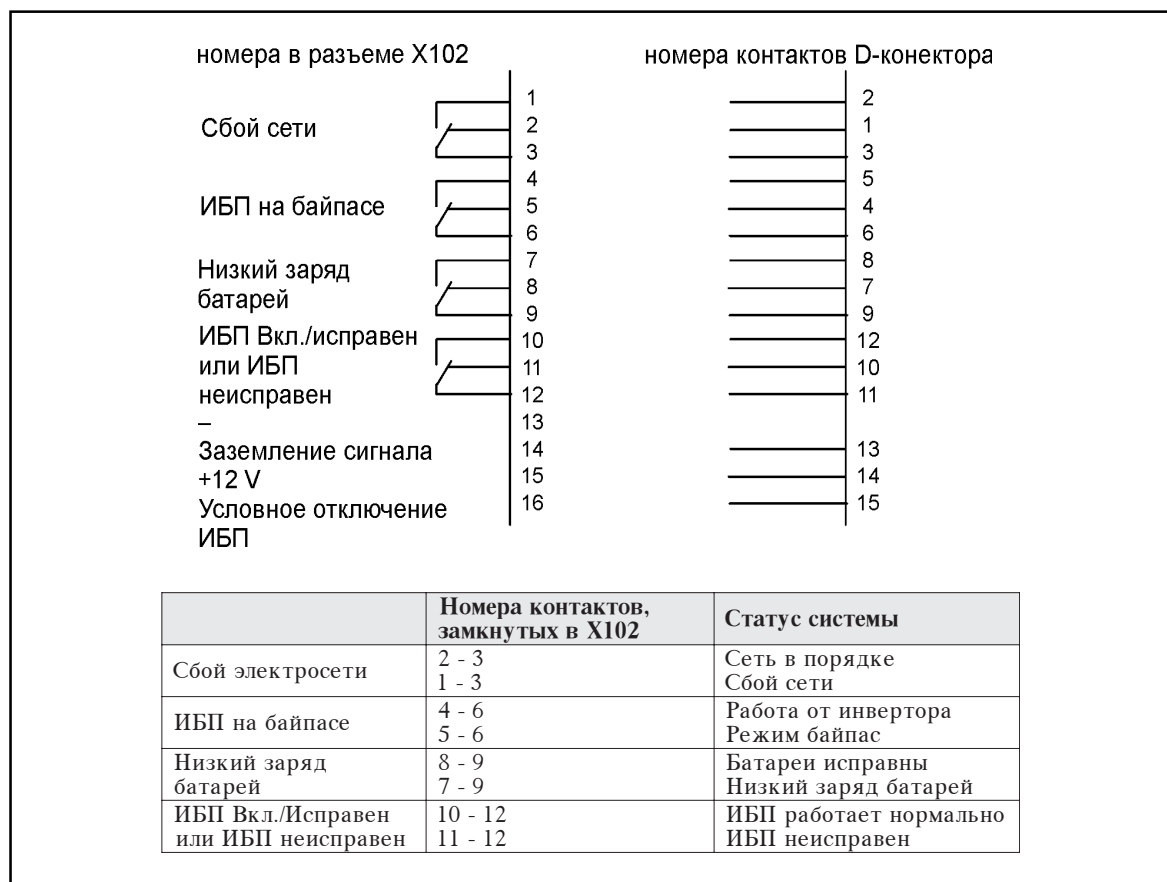
Рисунок 26. Релейный интерфейс ИБП (X102).
