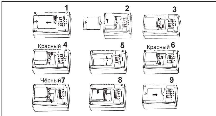
В ИБП номинальной мощности 700ВА используются аккумуляторные батареи 12В-7Ач.
