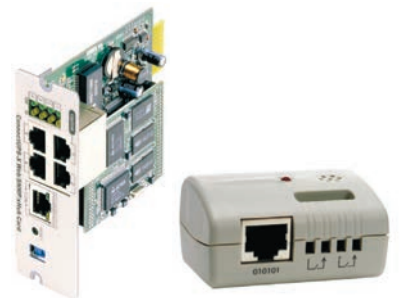
Адаптер Web/SNMP с датчиком параметров окружающей среды.
