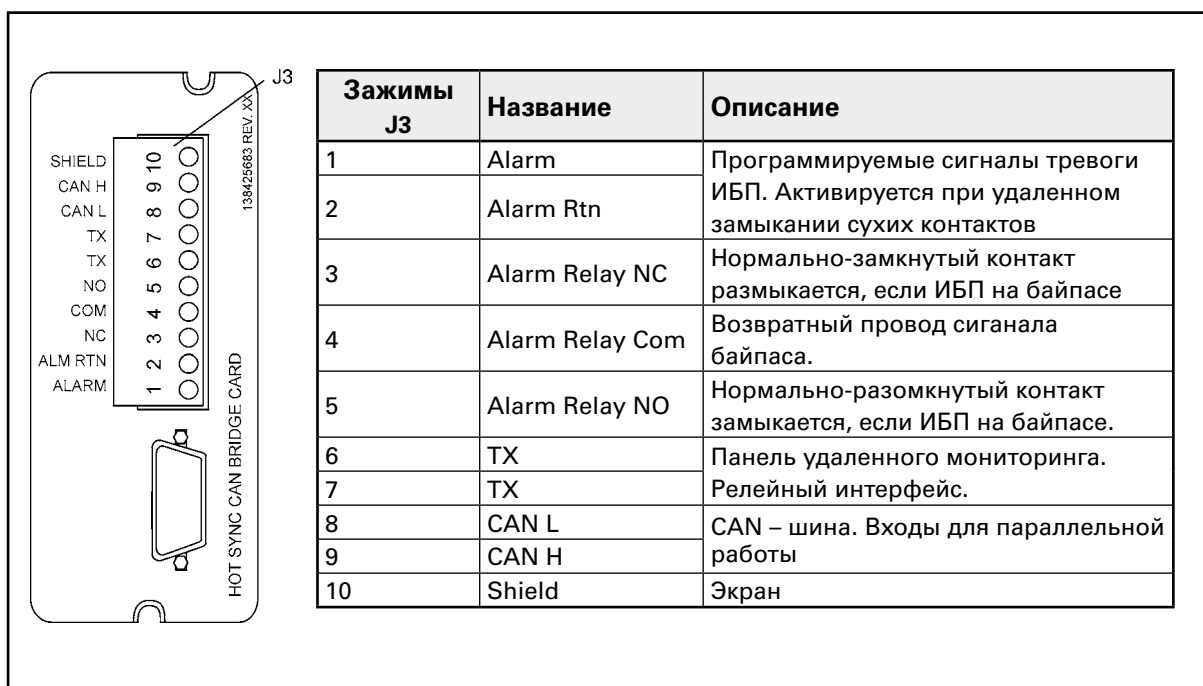
Рисунок 26 Адаптер XSlot Hot Sync и контактный интерфейс
