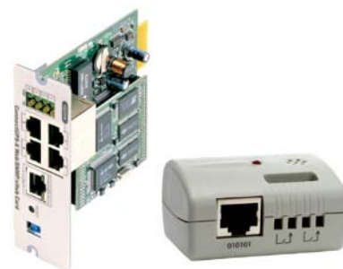
Адаптер Web/SNMP с датчиком параметров окружающей среды.
