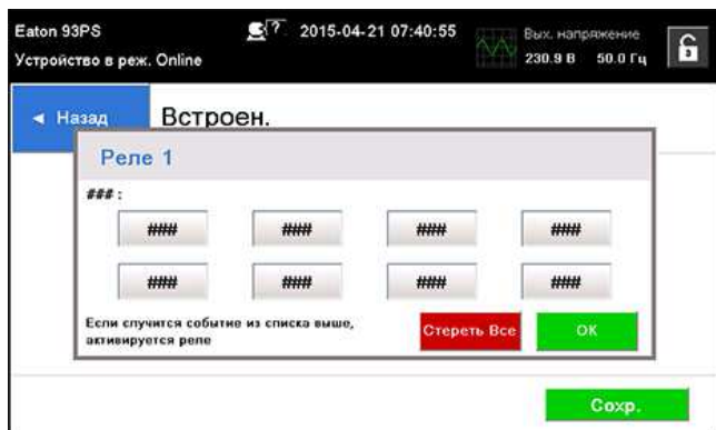
Рисунок 35. Ввод кодов функций, которые будут приводить к срабатыванию реле
