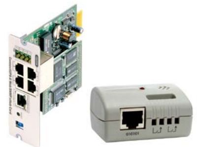
Адаптер Web/SNMP с датчиком параметров окружающей среды.
