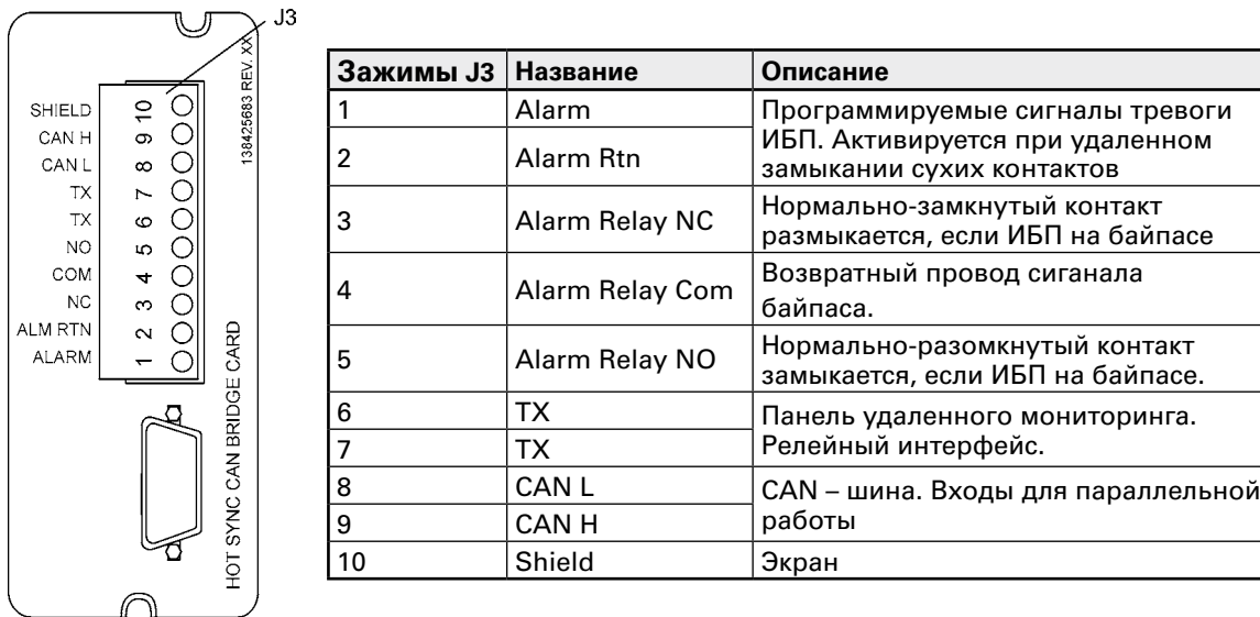
Рисунок 44. Плата XSlot Hot Sync и контактный интерфейс
