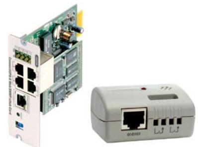
Адаптер Web/SNMP с датчиком параметров окружающей среды.
