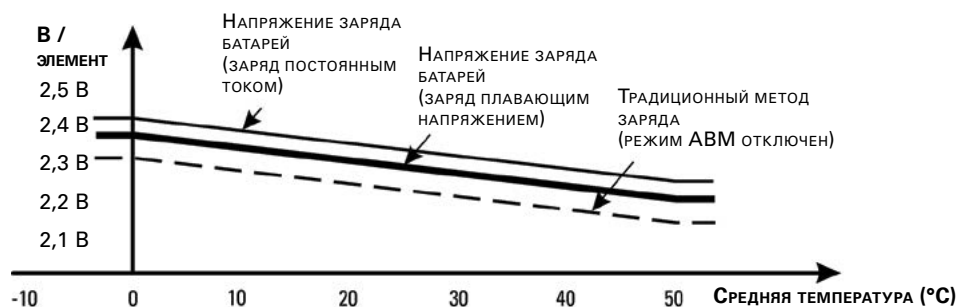
Температурная компенсация. Зависимость напряжения заряда от температуры.
