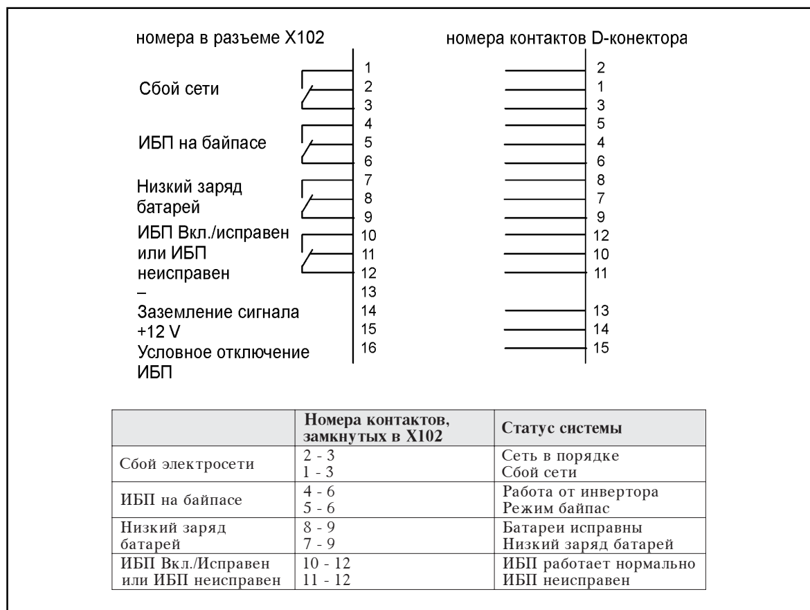
Рисунок 26. Релейный интерфейс ИБП (X102).
